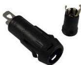
Drehen Sie den Sicherungshalter zum Öffnen nach Links und Sie erreichen die Gerätesicherung 250VAC 2x T 6,3 A/ H – Nach dem Sicherungswechsel wieder einsetzen und nach Rechts verschließen
