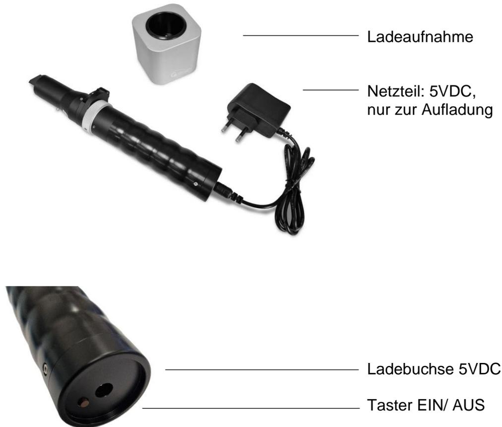
Bei Tastendruck schaltet sich die Akkuleuchte ein. Bei erneutem Tastendruck reduziert sich die Helligkeit 3mal um jeweils 20%, bis die Leuchte ausgeht. Danach wird sie über einen Tasterdruck wieder aktiviert.
